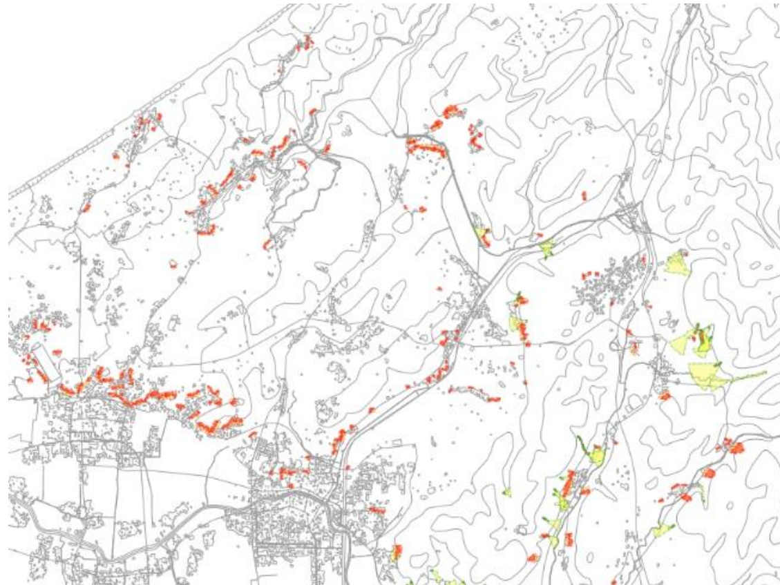
あわら市の土砂災害リスクのある箇所のマップ 赤は急傾斜地の崩壊リスク、黄は土石流リスクを指す
