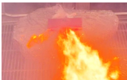
②数秒後、破損部分から白煙が上昇。その後、機器が膨張して開いた隙間から勢いよく炎が吹き出しました！
