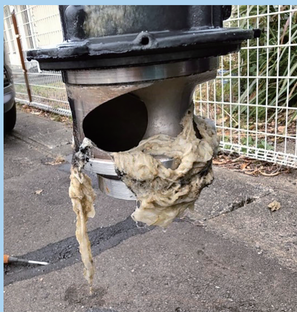
下水道管の中から発見された異物 ▶
