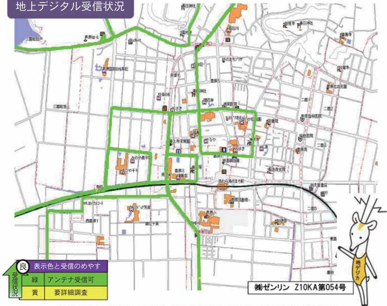
測定車を走行させながら、地上デジタル放送の受信状況を簡易的に調査した結果です。
