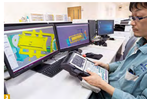
1 溶接した部品を組み立てるエリア。工場内は整然とし、安全管理が徹底されている 2 製造されたアームやブームなどの作業機は、「コマツ」ブランドの建機に取り付けられる 3 溶接ロボットに作業をプログラムする「オフラインティーチング」の様子
