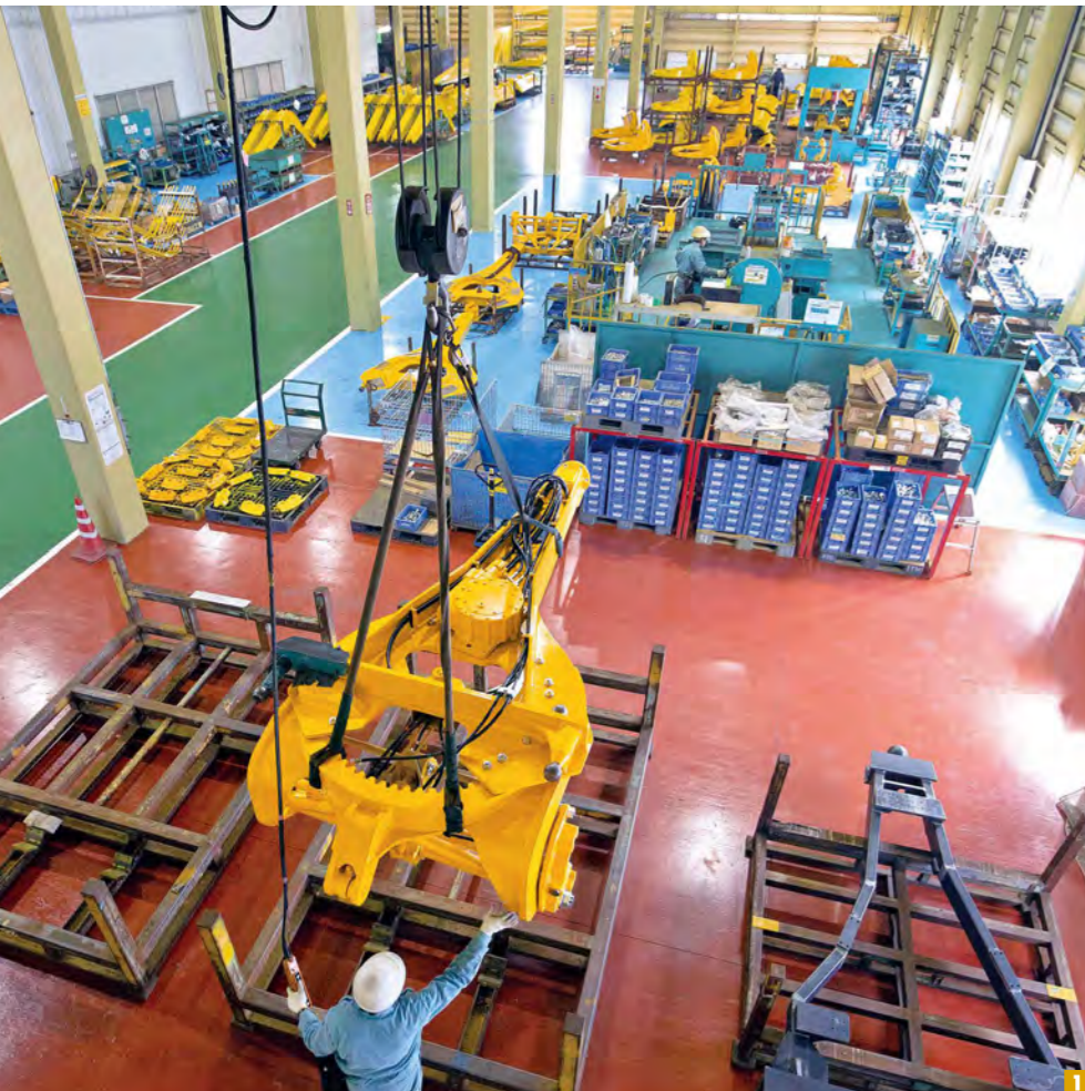
1 溶接した部品を組み立てるエリア。工場内は整然とし、安全管理が徹底されている 2 製造されたアームやブームなどの作業機は、「コマツ」ブランドの建機に取り付けられる 3 溶接ロボットに作業をプログラムする「オフラインティーチング」の様子
