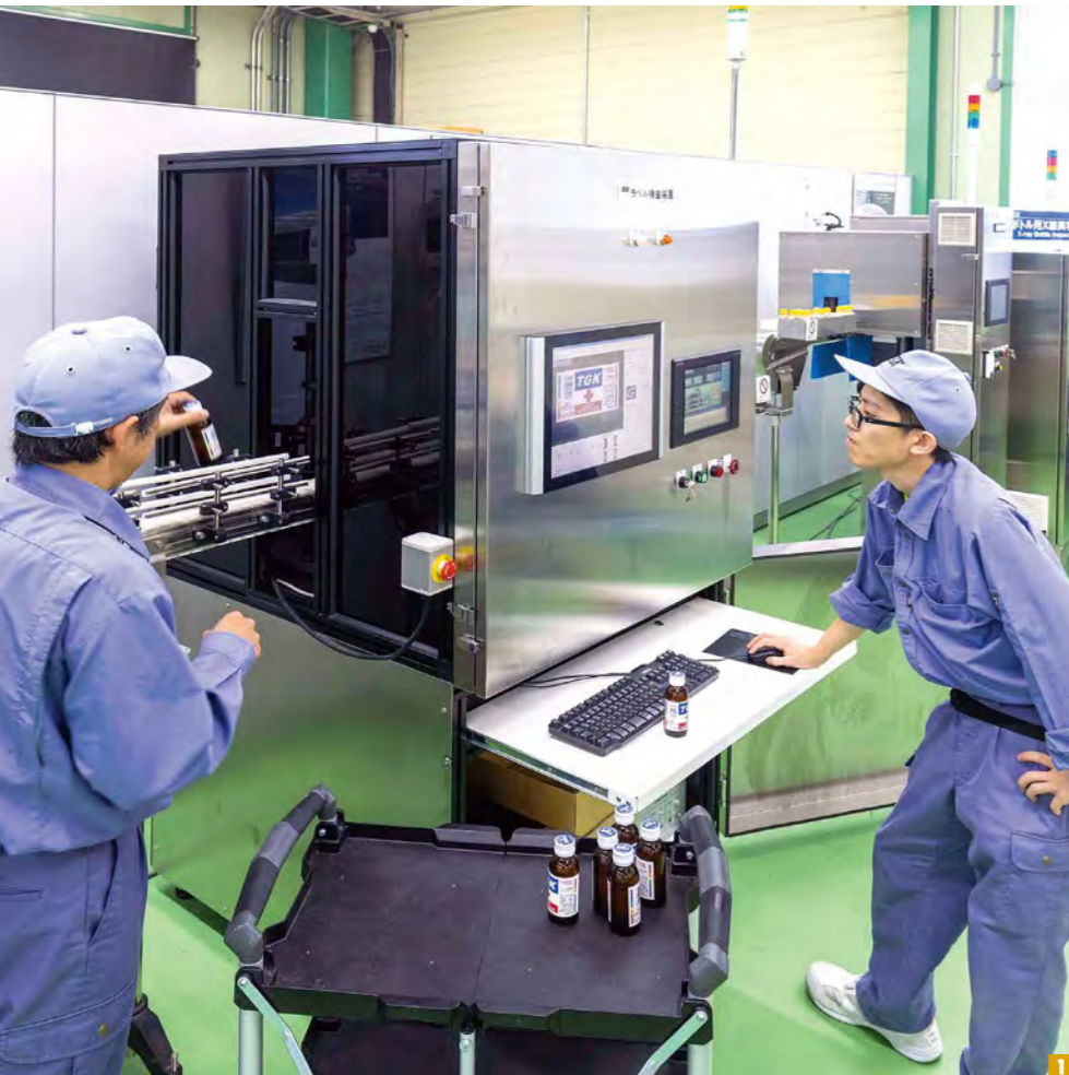
1 正しくラベルが貼付されているか瞬時に判別する装置。人の目では見逃してしまう箇所も判別できる 2 装置内のメンテナンスも自分たちの手で行う 3 創業は放送局用カメラの開発からスタートし、その後色彩選別機なども開発
