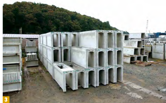
1 リサイクルした廃ガラスを用いたコンクリートで側溝などの製品を製造している 2 砕いたガラスびんを、実際の砂と同じような粒子の配合にして用いる 3 廃ガラスをリサイクルした「Gブロック」シリーズの製品は、各地の道路や農地で利用が進んでいる
