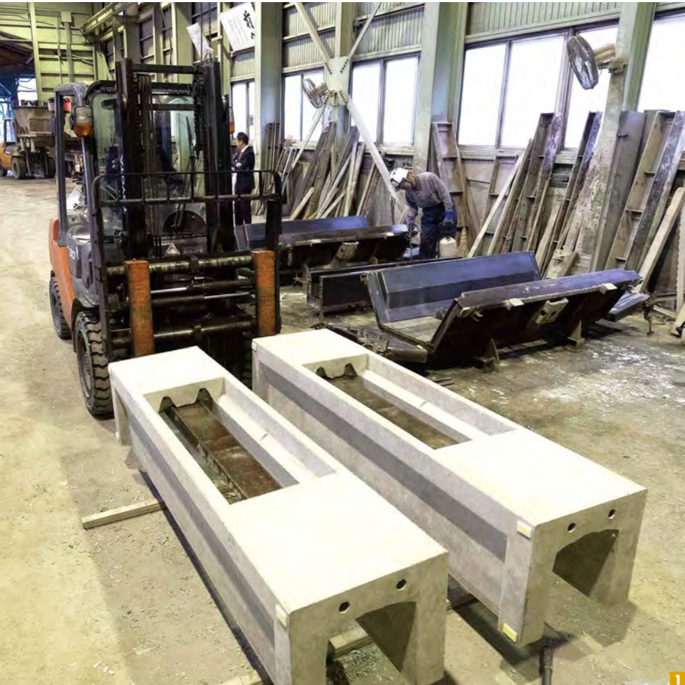
1 リサイクルした廃ガラスを用いたコンクリートで側溝などの製品を製造している 2 砕いたガラスびんを、実際の砂と同じような粒子の配合にして用いる 3 廃ガラスをリサイクルした「Gブロック」シリーズの製品は、各地の道路や農地で利用が進んでいる
