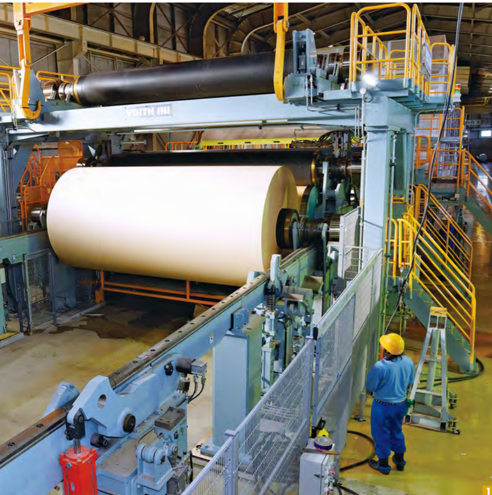
1 段ボール原紙をリールに巻き取っているところ 2 完成した紙に傷や汚れがないかどうかの最終チェックは、人が目で見て、手で触って実施する。点検者が靴を脱いでいるのは、自分たちの生活を支えている紙の上に土足では上がれないという思いからである 3 古紙を集積している広大な「古紙ヤード」
