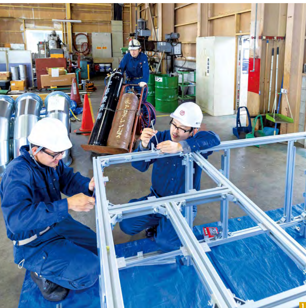
1 アルミフレームを使用し、オーダーメイドの製品枠を製作しているところ 2 金属加工には溶接が欠かせない。作業に当たるのは、JIS溶接技能者の資格取得者。同社には、ボイラー溶接士やボイラー整備士、管工事施工管理技士などの有資格者が揃っている 3 旋盤機械を使用し、精度の高い製品加工をしているところ
