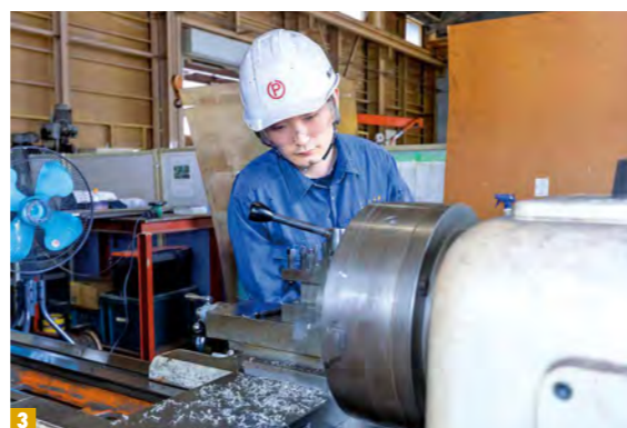
1 アルミフレームを使用し、オーダーメイドの製品枠を製作しているところ 2 金属加工には溶接が欠かせない。作業に当たるのは、JIS溶接技能者の資格取得者。同社には、ボイラー溶接士やボイラー整備士、管工事施工管理技士などの有資格者が揃っている 3 旋盤機械を使用し、精度の高い製品加工をしているところ
