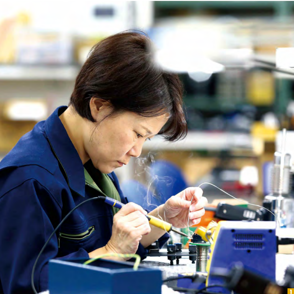
1 電子部品を熱で傷めることがないよう、素早くはんだ付けを進めていく 2 さまざまな電子部品が載ったプリント基板。一つ一つが全て手作業によるもの 3 多種多様の依頼に柔軟に対応できるよう、社屋を増築し万全の体制を整えている
