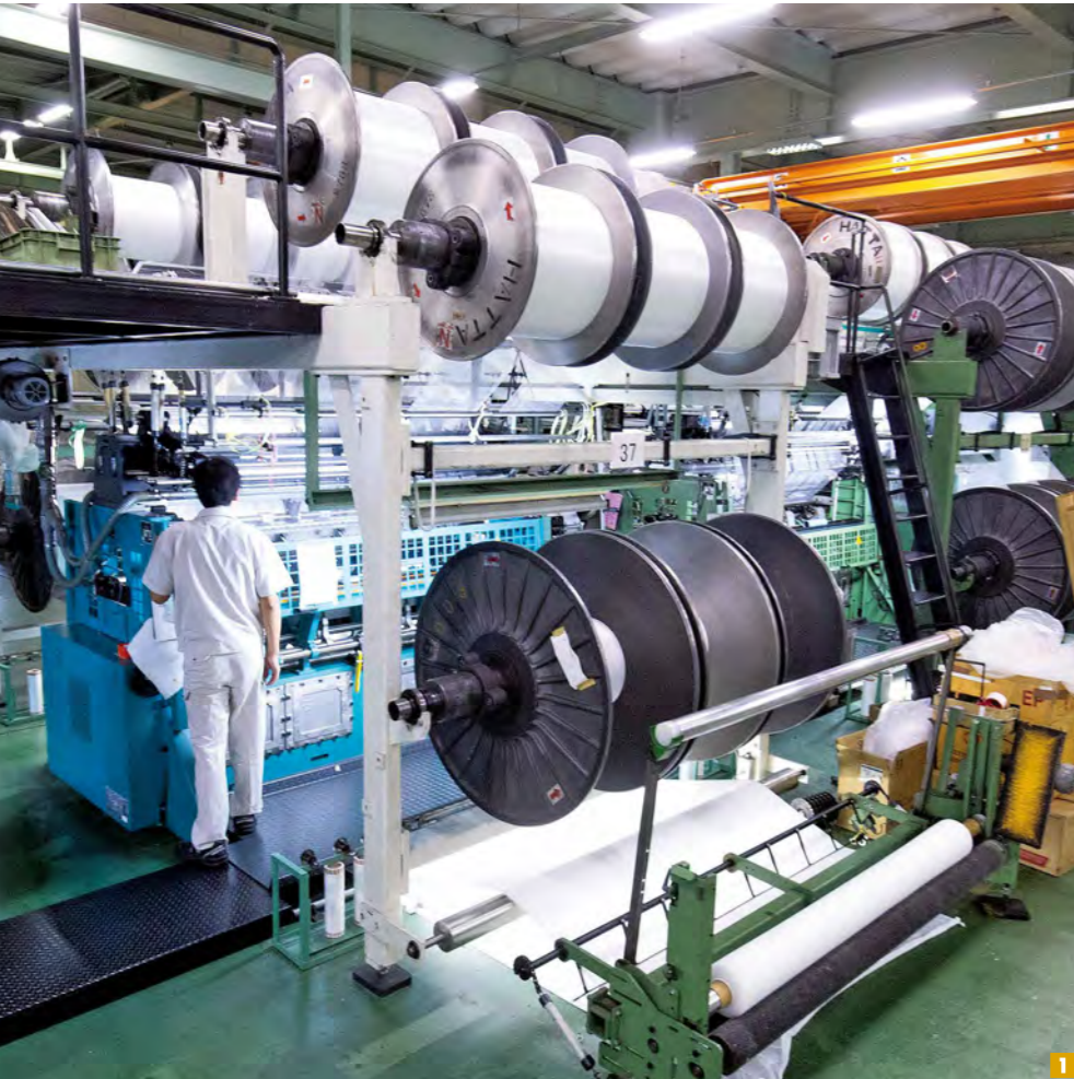
1 立体的な生地を編みだすことができるダブルラッセル機 2 糸をチェックするオペレーター 3 製造された生地は、ファッション衣料、ランニングシューズのメッシュ素材、化粧パフ、食器洗剤スポンジのたわし部分など、さまざまな製品に使われている
