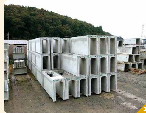
1 リサイクルした廃ガラスを用いたコンクリートで側溝などの製品を製造している 2 砕いたガラスびんを、実際の砂と同じような粒子の配合にして用いる 3 廃ガラスをリサイクルした「Gブロック」シリーズの製品は、各地の道路や農地で利用が進んでいる
