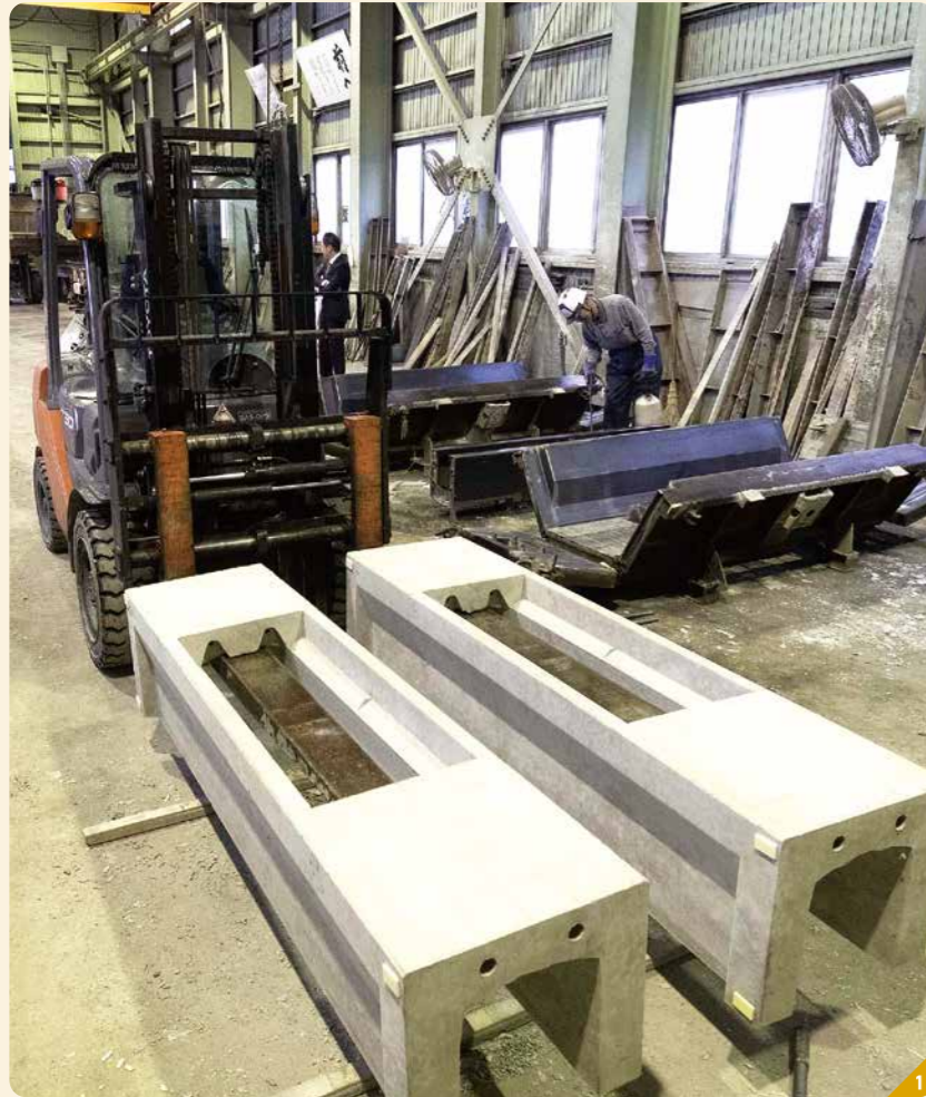
1 リサイクルした廃ガラスを用いたコンクリートで側溝などの製品を製造している 2 砕いたガラスびんを、実際の砂と同じような粒子の配合にして用いる 3 廃ガラスをリサイクルした「Gブロック」シリーズの製品は、各地の道路や農地で利用が進んでいる
