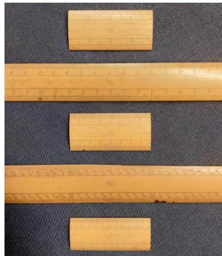
実際に図面を引くお仕事や学問をされる方の中には、現在もこの定規のミリメートル版を使われる方も多いでしょう。これは縮尺図を作る際に使用されるものさしです。例えば1/50尺のものさしでは、1メモリが50分の1尺（6.1ミリメートル弱）を表します。この物差しを使って図面を書くと50分の1の縮尺図を正確に作ることができる、という優れたものです。
