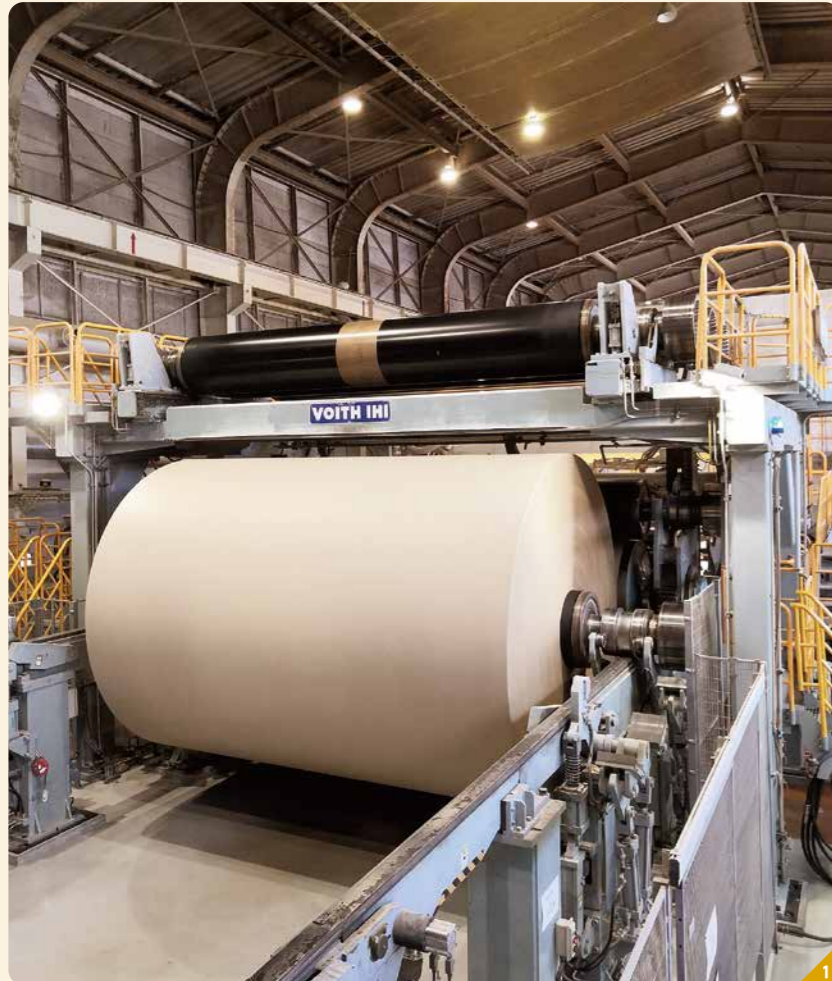
1 段ボール原紙をリールに巻き取っているところ 2 生産設備の制御や監視を行っているモニターが立ち並ぶ制御室。大画面モニターには気象情報や工場全体の生産・排水・紙質情報などがリアルタイムで集約・表示される 3 古紙を集積している広大な「古紙ヤード」
