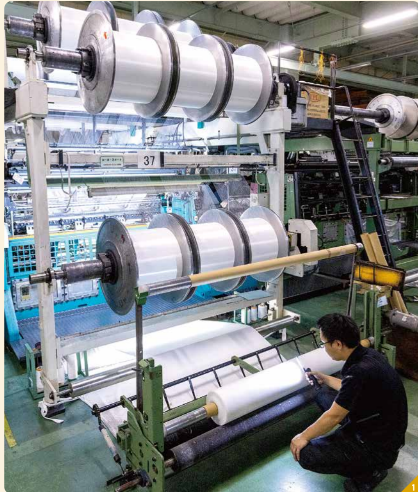
1 立体的な生地を編み出せるダブルラッセル機。仕上がった生地は、機械と人の目の両方で検査する 2 編み機にセットする経糸をポビンに巻く整経作業。1分間に約400mのスピードで巻き取られていく 3 製造された生地は、アウトドアウェアや高級ブランドの服などに使われている
