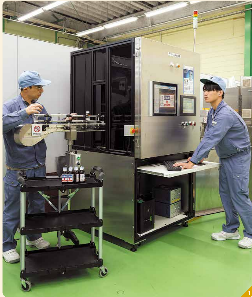
1 正しくラベルが貼付されているか瞬時に判別する装置。人の目では見逃してしまう箇所も判別できる 2 装置内のメンテナンスも自分たちの手でやる 3 創業は放送局用カメラの開発からスタートし、その後色彩選別機なども開発
