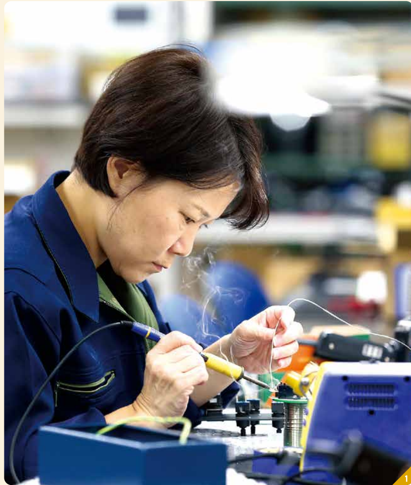
1 電子部品を熱で傷めることがないよう、素早くはんだ付けを進めていく 2 さまざまな電子部品が載ったプリント基板。一つ一つが全て手作業によるもの 3 多種多様の依頼に柔軟に対応できるよう、社屋を増築し万全の体制を整えている
