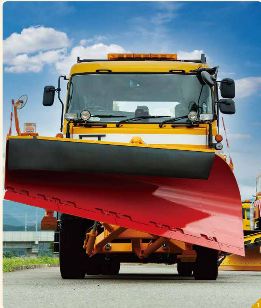
1 車体前面に「スノーブラウ」を装着した除雪トラック。全国各地の交通インフラの安定に貢献 2 除雪装置「トラックグレーダ」を組み立てる様子 3 完成した除雪トラックは、品質保証部の社員が検査を行う
